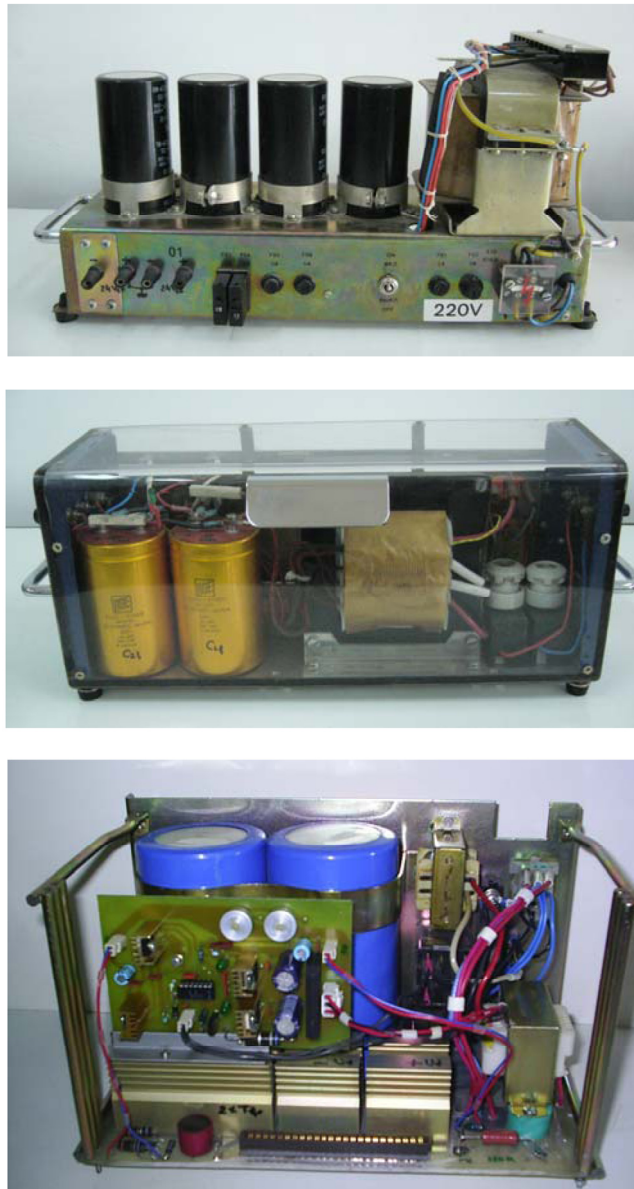
Fig. 8.13 Variante de surse existente în Laboratorul de Electronică de Putere realizate cu redresoare monofazate în punte și filtre capacitive.
