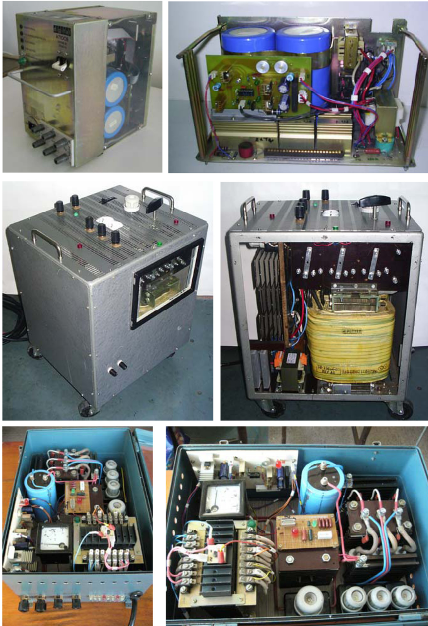
Fig. 16.10 Variante de alte surse din Laboratorul de Electronică de putere realizate pentru alimentarea chopper -elor și a invertoarelor PWM.
