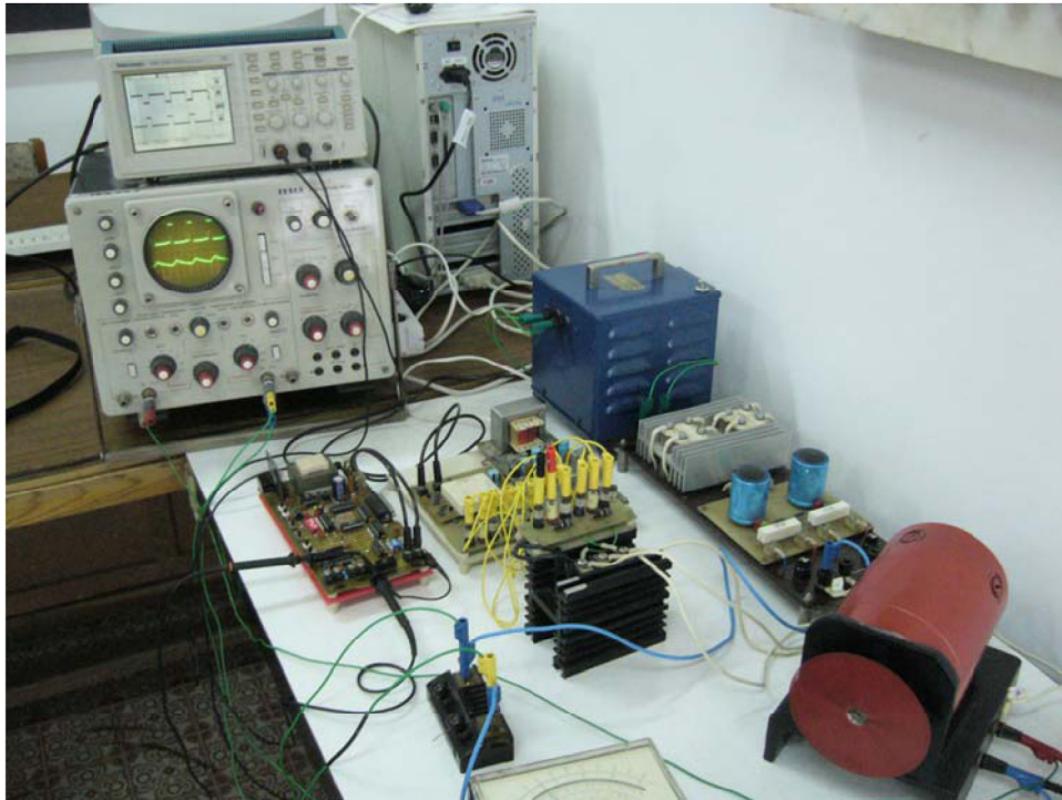
Fig. 18.9 Imaginea montajului de laborator al convertorului c.c. – c.c. cu funcționare în două cadrane cu formele de undă oscilografiate.
