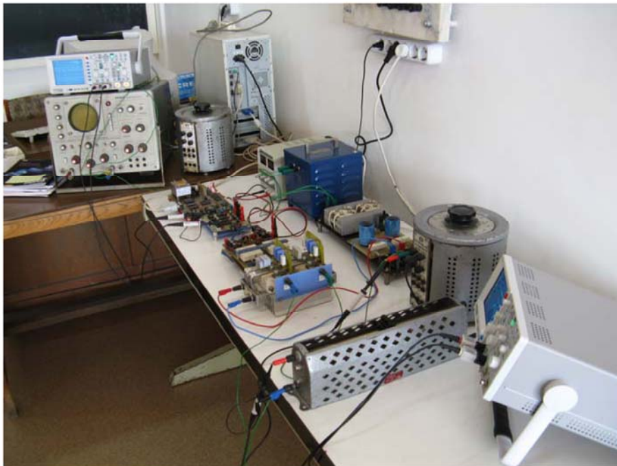
Fig. 25.19 Imaginea de ansamblu a montajului de laborator pentru studiul invertorului PWM monofazat.
