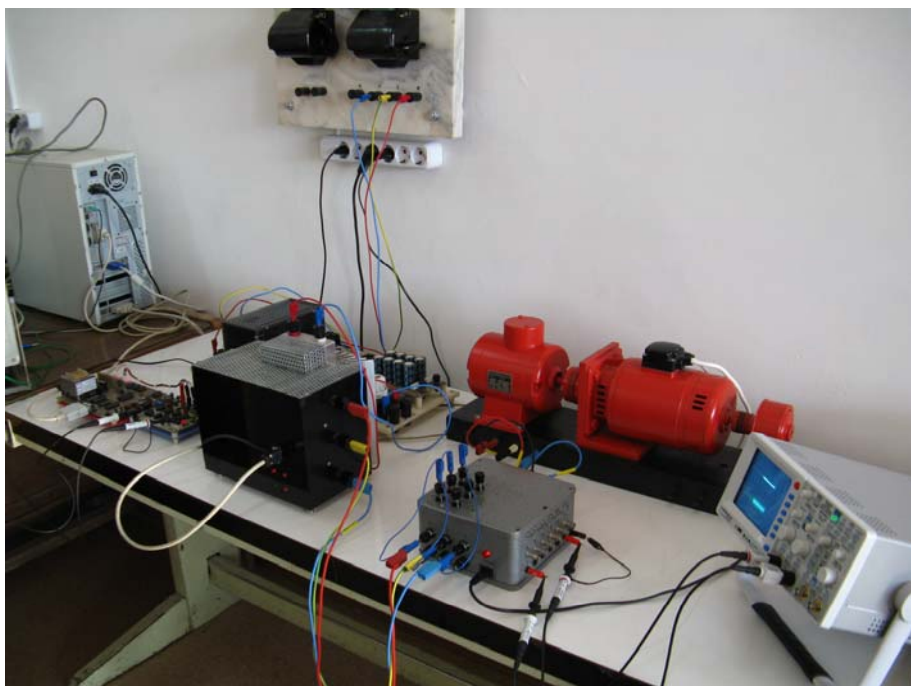
Fig. 26.13 Imaginea de ansamblu a montajului de laborator care include a doua variantă de inverter PWM trifazat (realizat în construcție închisă - cu module de comandă SKHI22A) și modulatorul PWM în variantă analogică.
