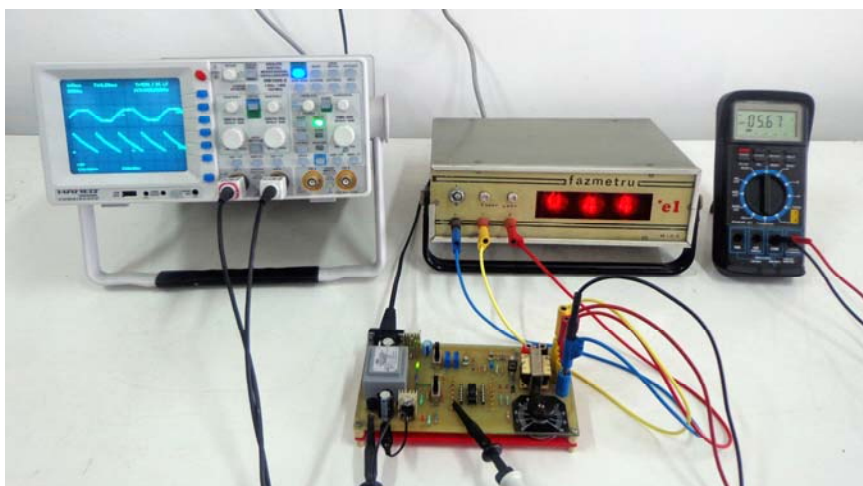
Fig. 3.12 Imaginea montajului de laborator pentru oscilografiera semnalelor și trasarea caracteristicii \alpha = f(U_{c-dă}) a circuitului \beta AA145 (UAA145).
