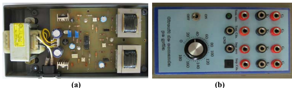
Fig. 3.11 Circuit de comandă cu \beta AA145 pentru diferite structuri de redresoare monofazate (cu maxim 4 tiristoare – vezi Fig.3.5) ; (a) imagine din interiorul carcasei; (b) panoul frontal al circuitului.
