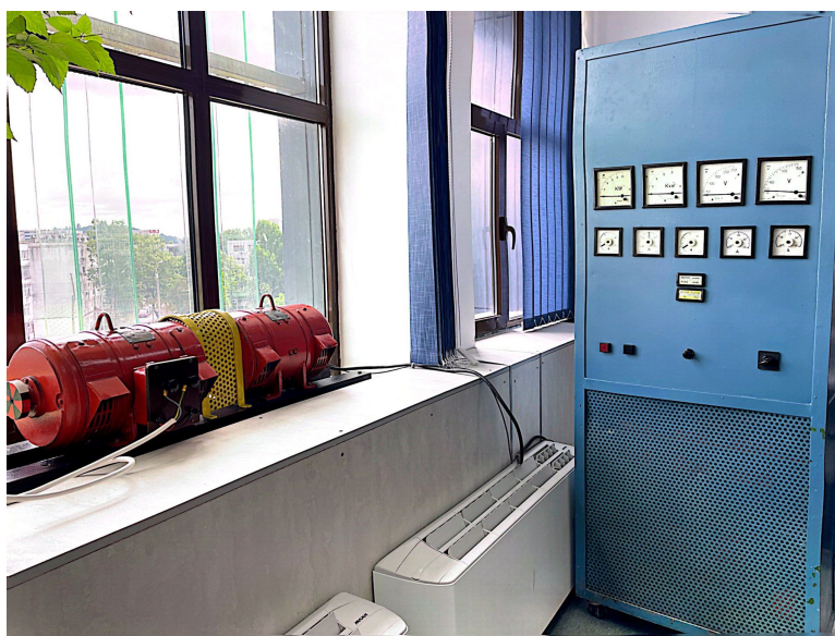
Fig.15.10 Imaginea standului de laborator pentru studiul redresorilor bidirecționale având ca sarcină de 4 cadrane un motor de c.c.
